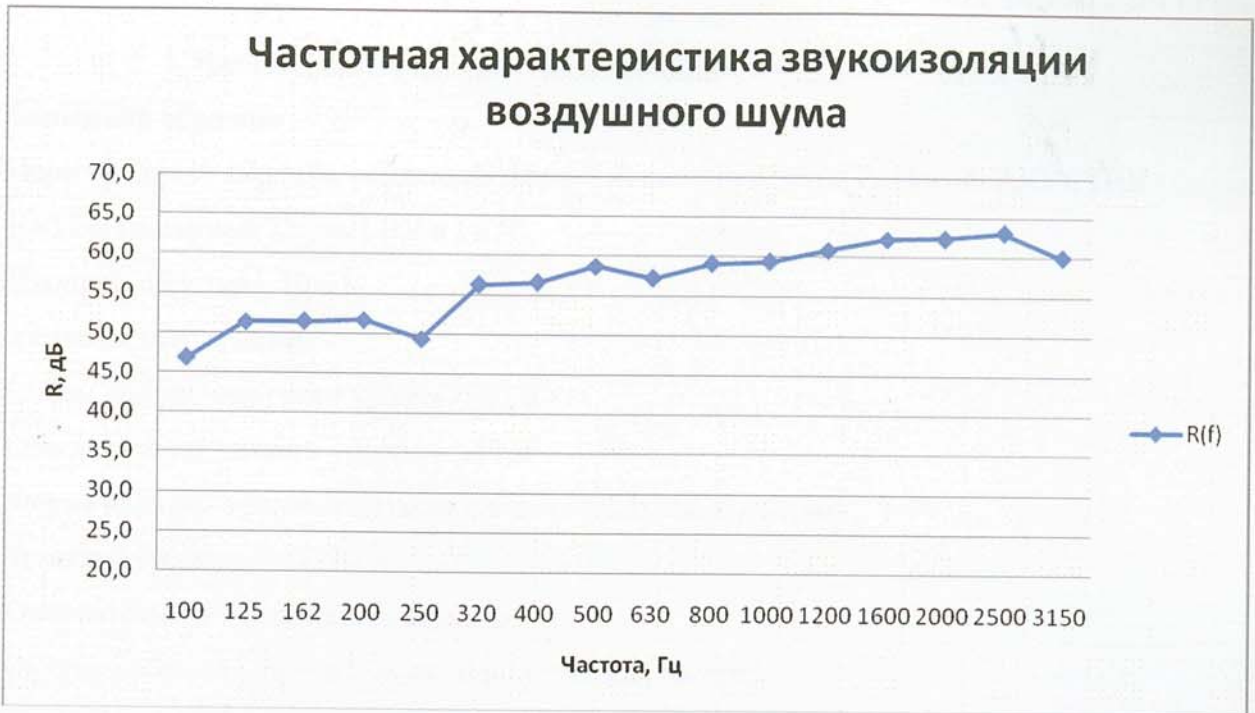
Рис.8. Частотная характеристика изоляции воздушного шума конструкции 3.
