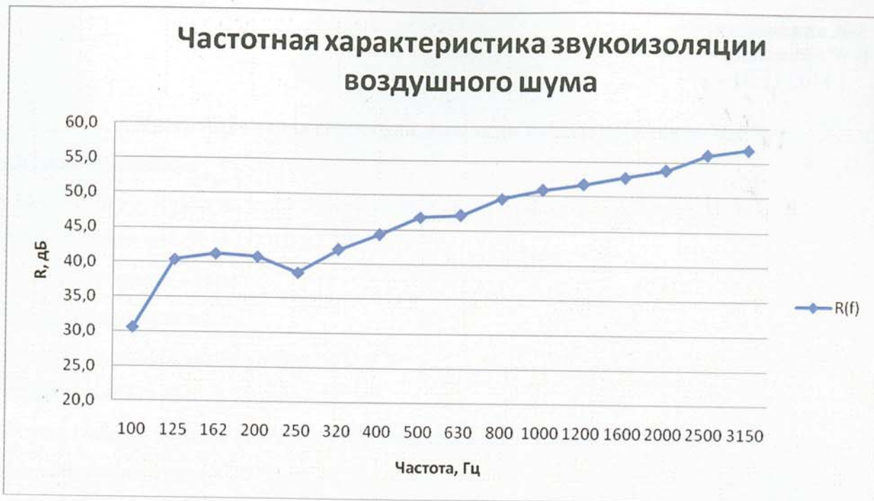
Рис.6. Частотная характеристика изоляции воздушного шума конструкции 1.
